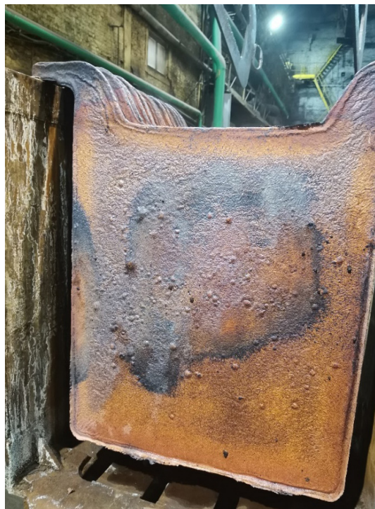
Рисунок 4 – Медный анод, отлитый с использованием покрытия «Литоформ» марки 900
