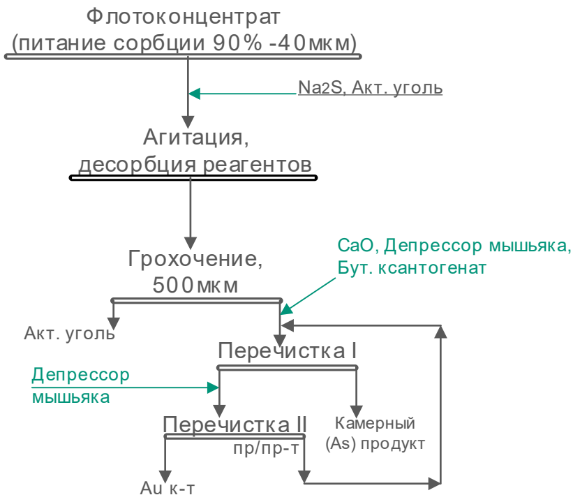
Рисунок 2 –Схема процесса селективного разделения золота и мышьяка флотацией
