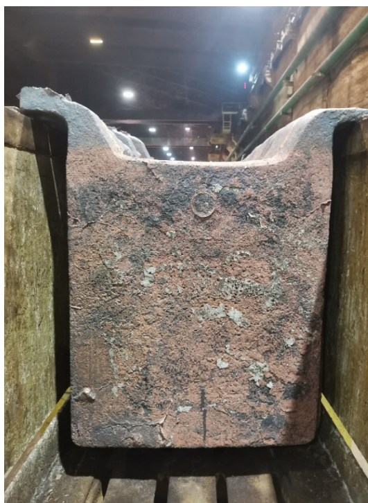
Рисунок 2 – Медный анод, отлитый с использованием шамотного мертеля
