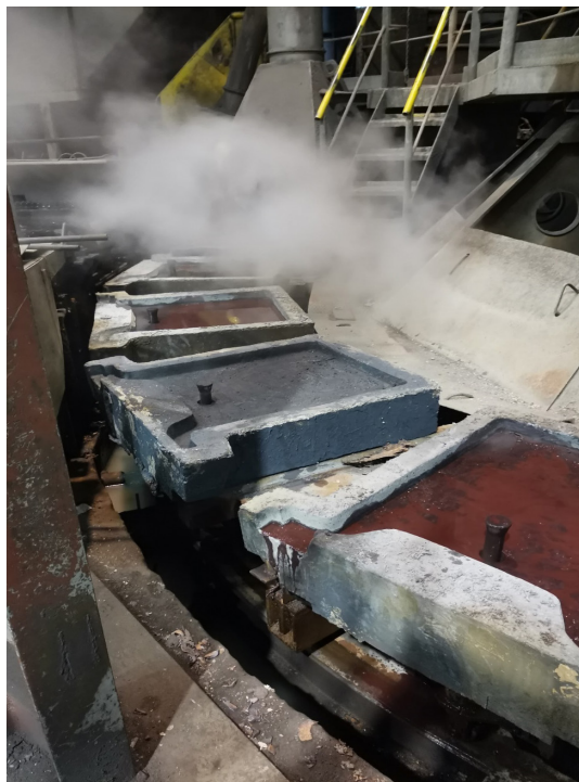
Рисунок 3 – Изложницы, обработанные суспензией противопригарного покрытия «Литоформ» марки 900
