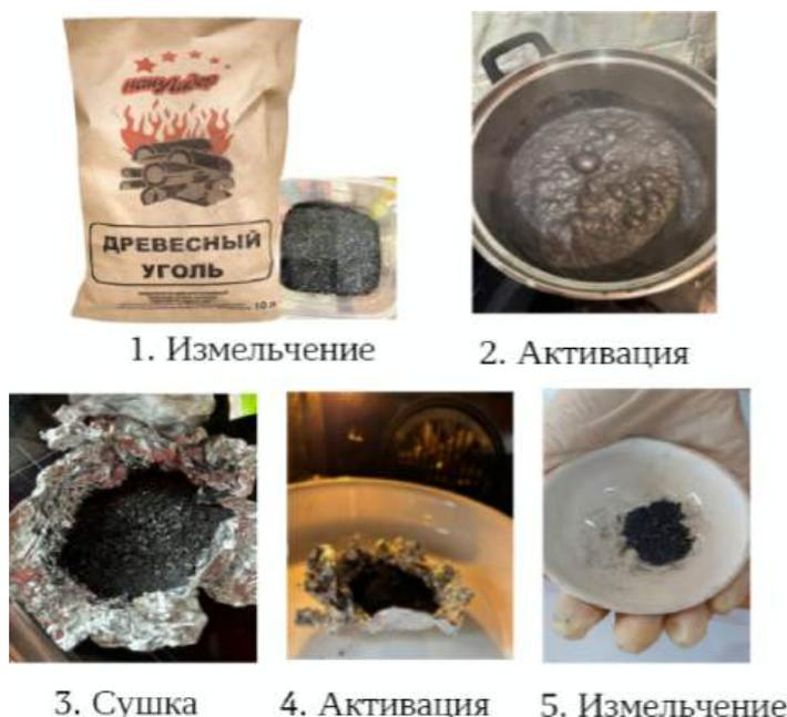
Рис. 4. Стадии производства собственного активированного угля»
