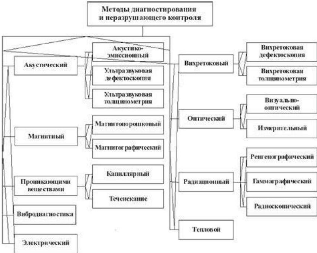
Рис. 1. Методы неразрушающего контроля [7; 44]
