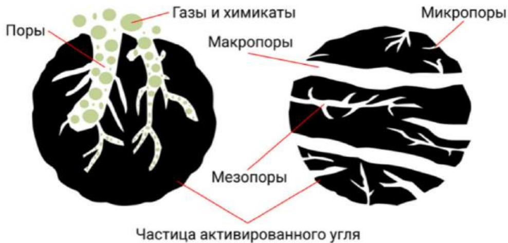
Рис. 2. Механизм адсорбции активированным углем
