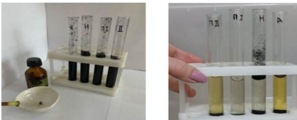
Рис. 7. Определение йодного числа
