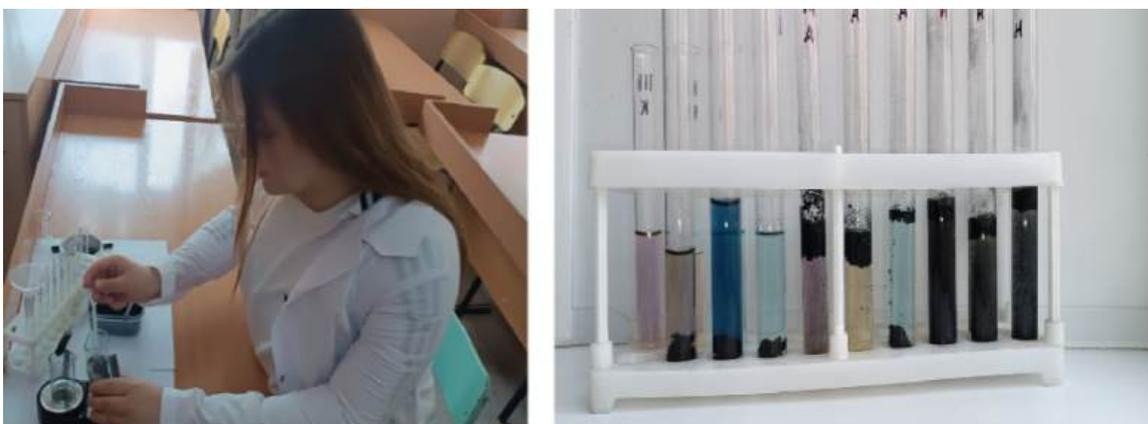
Рис. 6. Определение адсорбирующих свойств углей
